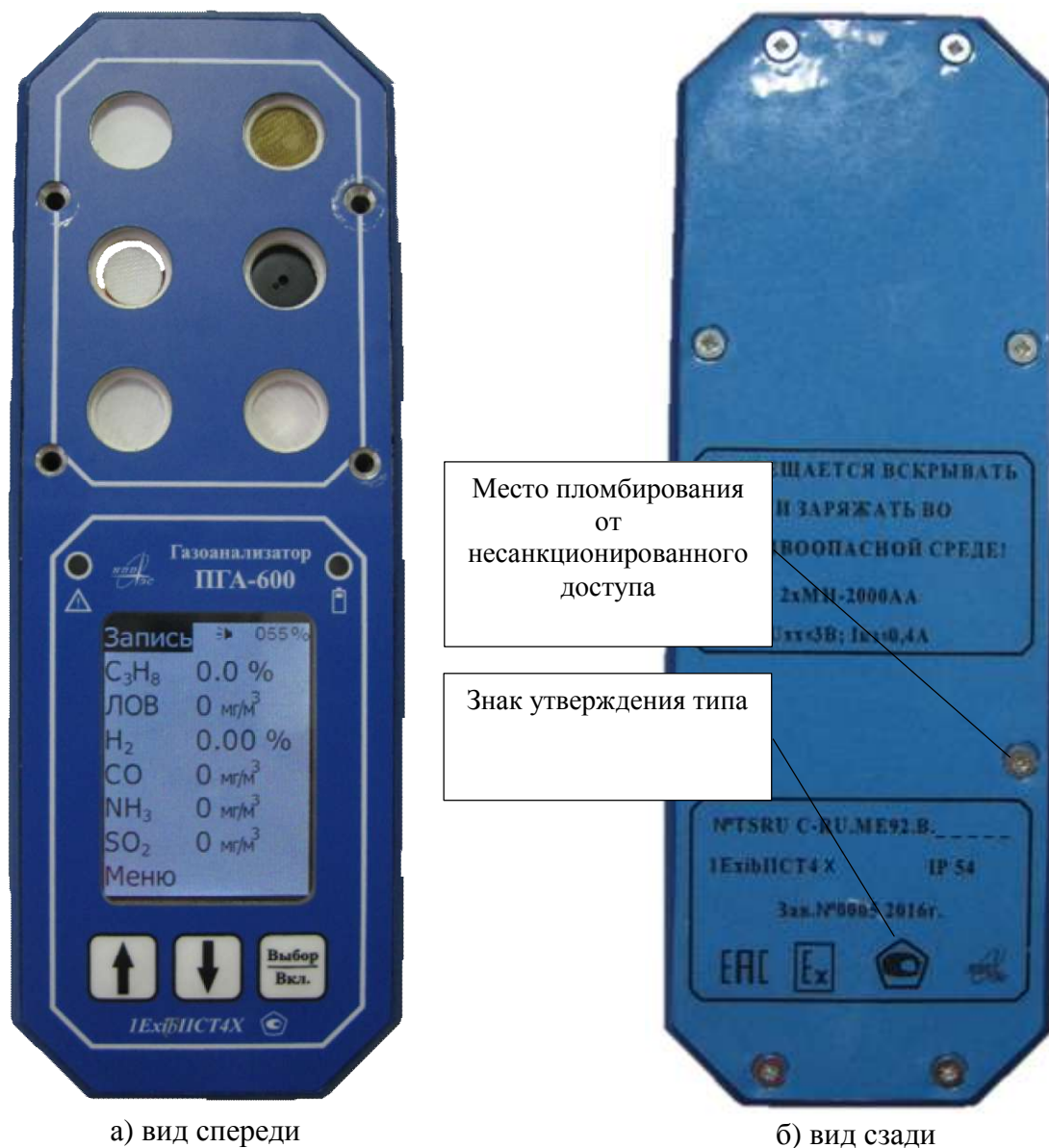
а) вид спереди б) вид сзади Рисунок 1 - Внешний вид газоанализатора ПГА-600
