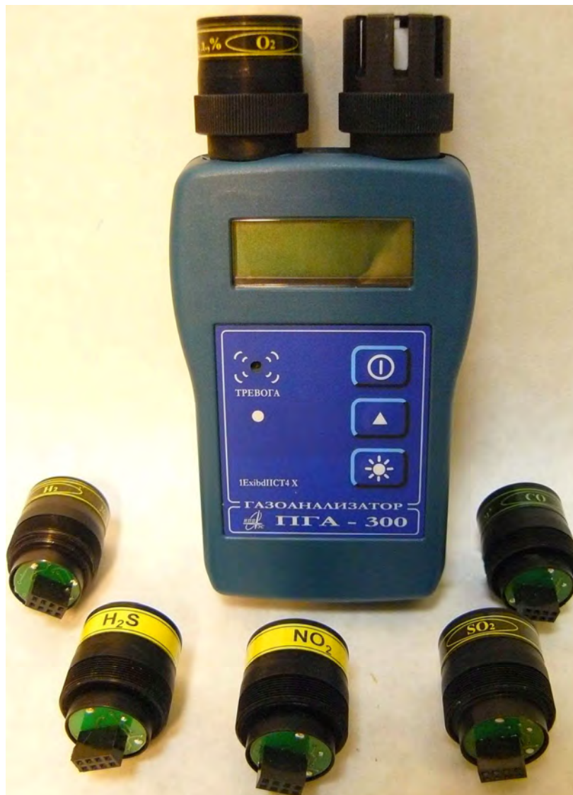
Рисунок 1 – Внешний вид газоанализаторов ПГА-300
