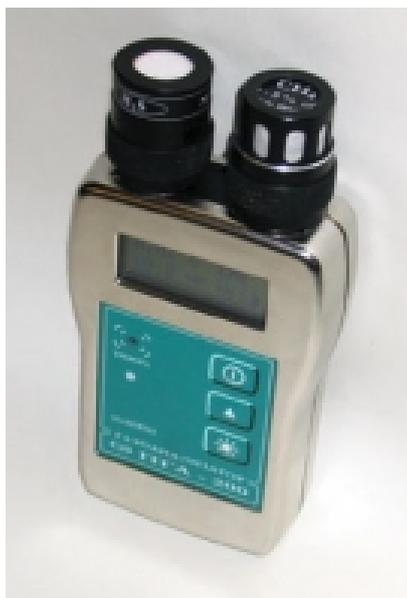
Газоанализатор ПГА-200 предназначен для измерений концентрации взрывоопасных газов - метана, пропана, токсичных газов - оксида углерода, сероводорода, диоксида азота, диоксида серы а также кислорода и углекислого газа. Газоанализатор имеет портативную конструкцию со сменными оптическими и электрохимическими датчиками. Область применения - промышленная безопасность и контроль воздуха рабочей зоны.
