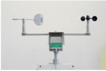
Анемометр ДВЭС-2 предназначен для измерений скорости и направления воздуха (ветра), передачи мгновенных значений и усредненных результатов измерений по цифровым каналам связи в стандарте RS-485 в виде ASCII - кодов на внешние устройства отображения информации или системы сбора метеорологических данных. Является средством измерений, свидетельство об утверждении типа средств измерений RU.C.28.001.A №52691. Периодичность поверки - 1 год.
